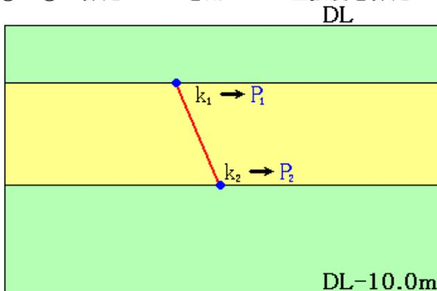
《海底面～海底面-10m間の土圧強度を直線補間(土層下限値のみ補間で算出)》
