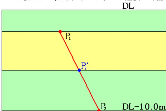
《海底面～海底面-10m間の土圧強度を直線補間(土層上・下限値共に補間で算出)》
