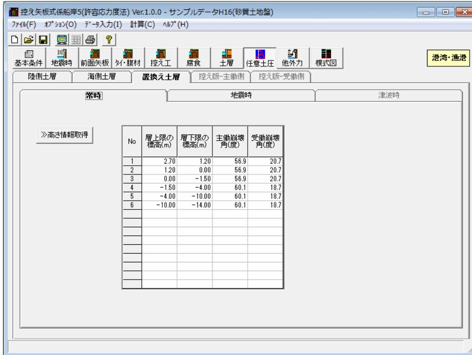
置換え土層を考慮する場合、各土層の上限・下限毎に、崩壊角を入力します。この崩壊角は、前面矢板と控え工の間の距離（傾斜がない場合のタイ材長さ）を計算するために主働・受働の崩壊角が必要です。
