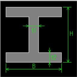
【控え工形式】が「H形鋼指定」の場合、形状を指定します。入力されたデータから腐食前の I、Z を自動計算する場合は、I、Z の項目は入力しないでください。メーカーカタログの値などを使用する場合、I、Z の項目にデータを入力してください。
