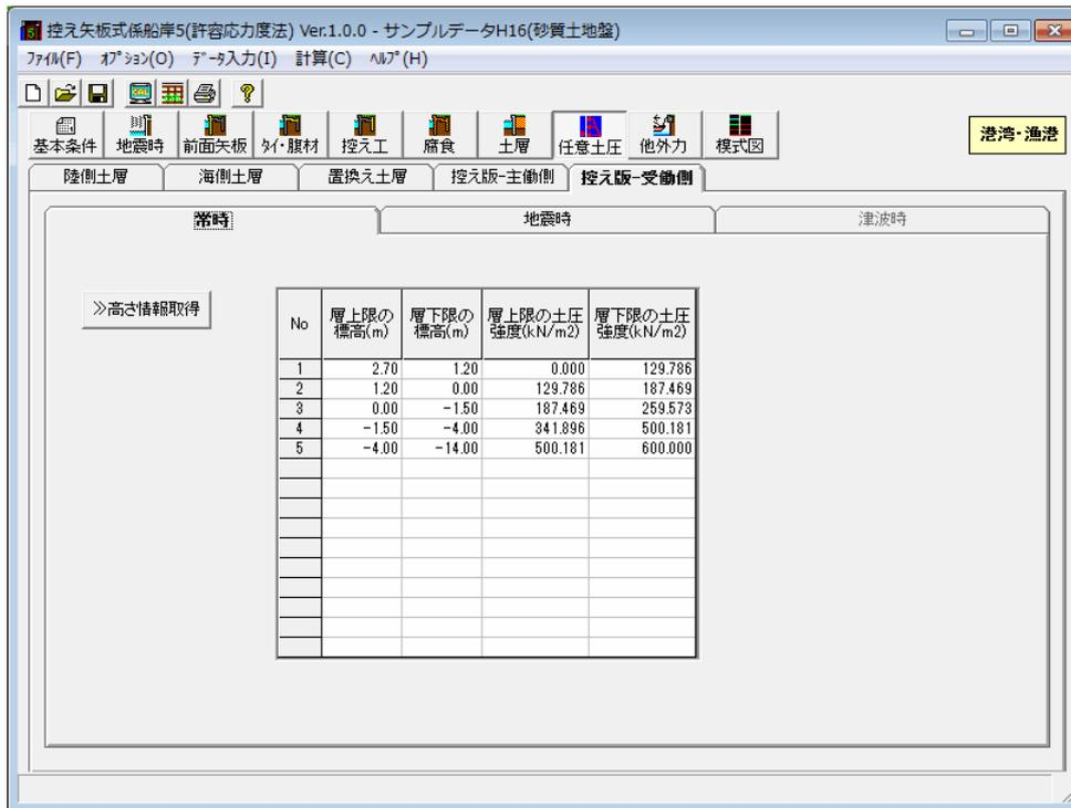
高さ情報取得ボタンを押せば、「土層」-「陸側」あるいは、「土層」-「置換え土層」の基準となる高さデータを取得します。
