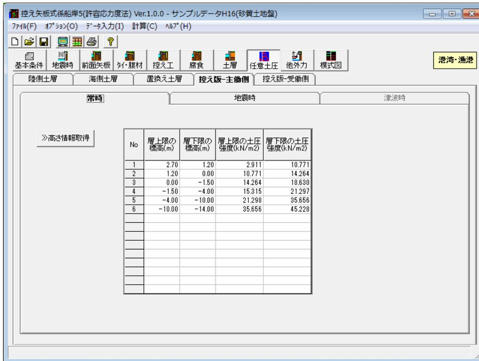
控え工の形式が「控え版」の場合、控え版の安定検討を行うための主働側の土圧強度を各土層の上限値・下限値で入力します。
