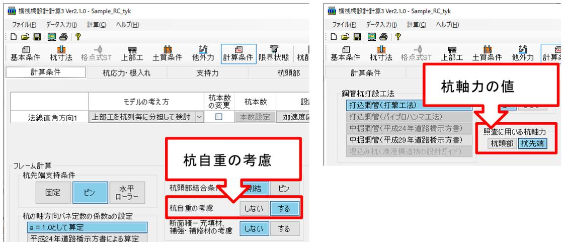
帳票で、例えば、支持力の照査で用いる荷重項(永続状態の杭1列目の杭軸力)の値は、杭反力の算定→最大曲モーメント及び1.0mおきのモーメント・せん断力の帳票より確認することができます。
