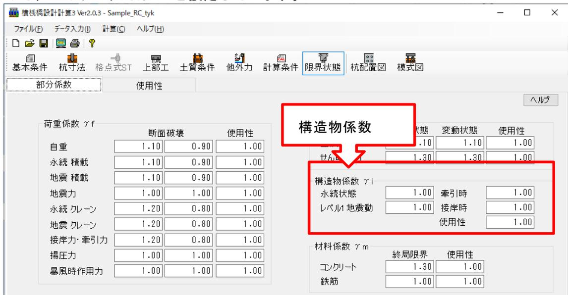
照査内容は、安全性—曲げに対する検討、使用性—曲げひび割れに対する検討、スタッド—設計せん断力の3項目になります。
